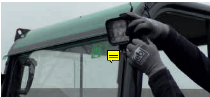
Anbringung eines Arbeitsscheinwerfers.
